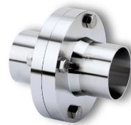
**Der Standard O-Ring ist aus FDA (Food and Drug Administration) zugelassenem EPDM, jedoch sind jederzeit auch alle gängigen Elastomerwerkstoffe möglich. Die Verbindung wird im Standard - Werkstoff 1.4435 und 316L in den Ausführungen Kleinflansch, Verschraubung und Clamp von DN 6-DN 200 (in Sonderfällen als Flansch bis DN 700) angeboten. Sonderwerkstoffe wie z.B 1.4539, Hastelloy, Alloy 59 oder Al6XN sind ebenfalls lieferbar.**
