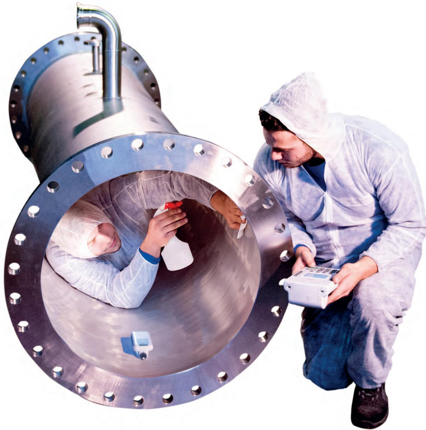
Bild: Spool DN700 für die chemische Industrie, produziert von NEUMO.
